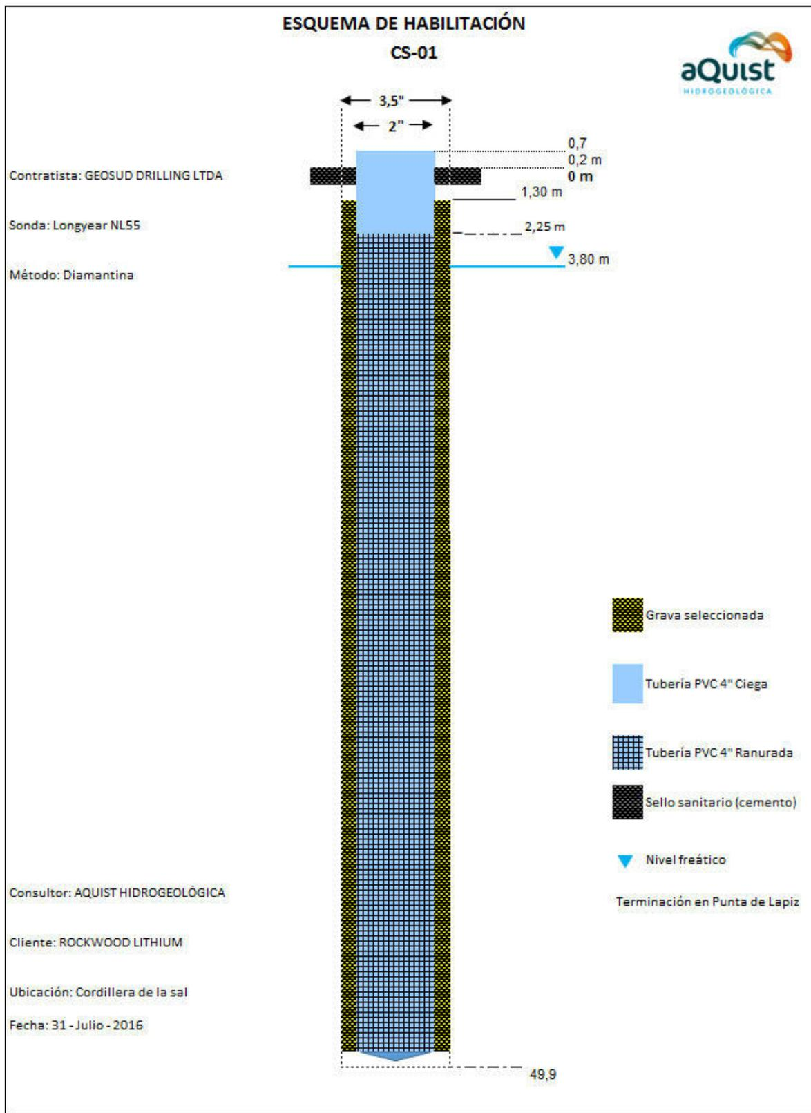
**Figura 2-1. Esquema de habilitación del piezómetro CS-01**
